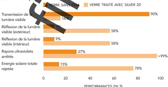
Les résultats reflètent une installation à l'intérieur d'un simple vitrage transparent de 4 mm d'épaisseur et d'un double vitrage transparent de 4mm@4mm.
